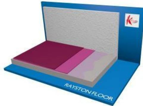
BASE: Hormigón, >28 días de curado, humedad <4%, sin humedad capilar, resistencia >1,5N/mm<sup>2</sup>, Temp. > 10°C, sin ningún tipo de contaminación, grasa, polvo o poro abierto
