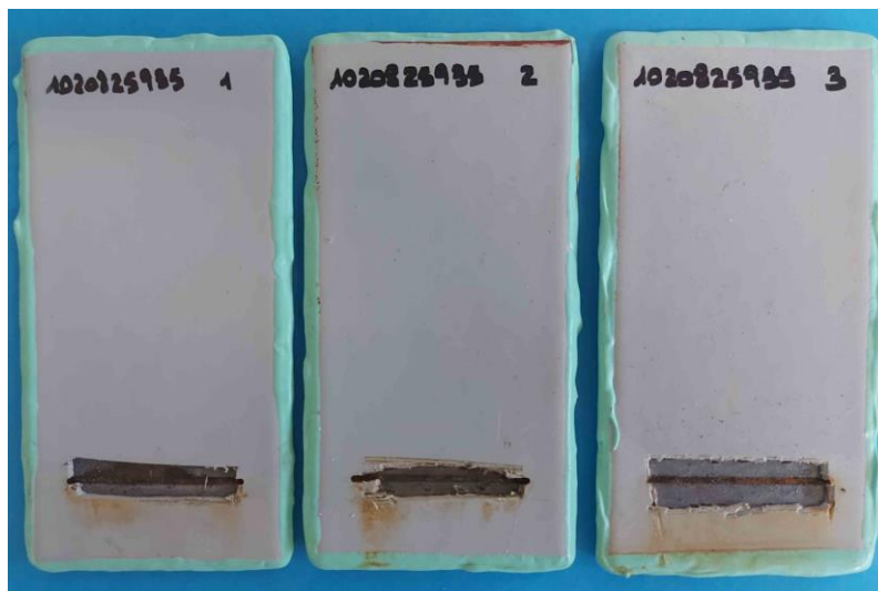
Figura 3.- Avance de la corrosión en las probetas “1”, “2” y “3” después de la exposición a la niebla salina neutra durante 1440 h.
