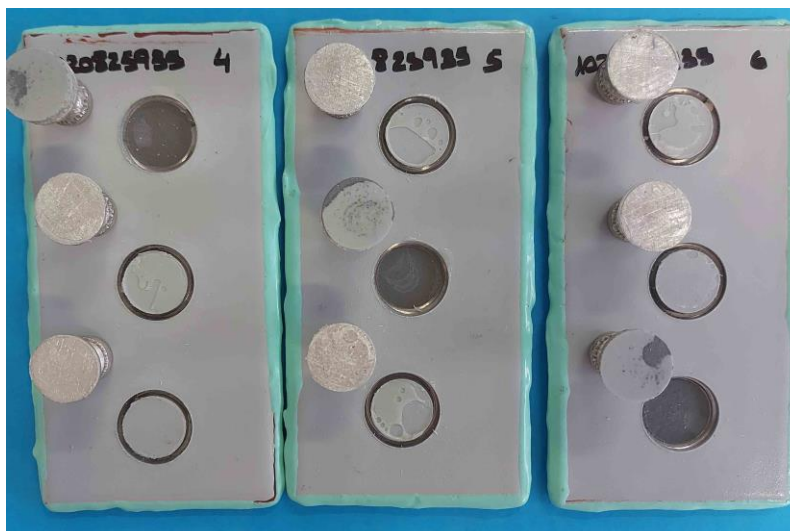
Figura 6.- Aspecto de las sufrideras y de las superficies de rotura en el ensayo de adherencia realizado en las probetas que han sido sometidas al ensayo de resistencia a la humedad en condiciones de condensación.
