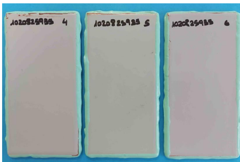
Figura 5.- Aspecto de las probetas “4”, “5” y “6” después de la exposición a la humedad en condiciones de condensación.
