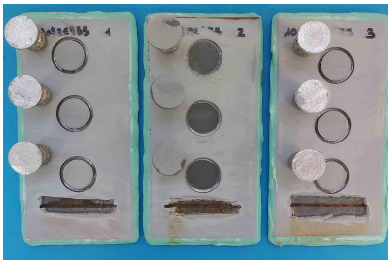
Figura 4.- Aspecto de la sufrideras y de las superficies de rotura en el ensayo de adherencia realizado en las probetas que han sido sometidas al ensayo de resistencia a la niebla salina neutra.
