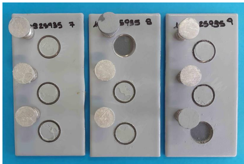
Figura 1.- Aspecto de las sufrideras y de las superficies de rotura en el ensayo de adherencia realizado en las probetas que no han sido sometidas a ensayo.
