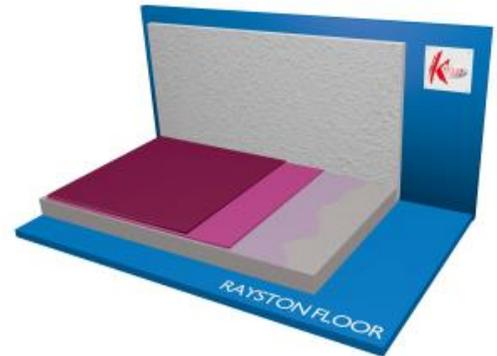
BASE: Hormigón, >28 días de curado, humedad <4%, sin humedad capilar, resistencia <1,5N/mm<sup>2</sup>, Temp. > 10°C, sin ningún tipo de contaminación, grasa, polvo o poro abierto
